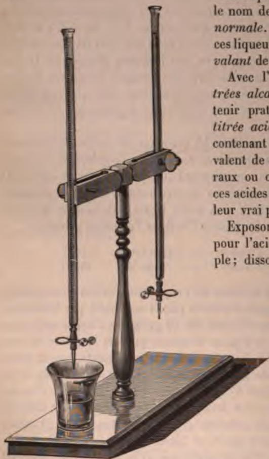
Fig. 215. — Burette à pincés de Mohr (modification de la burette de Gay-Lussac).
